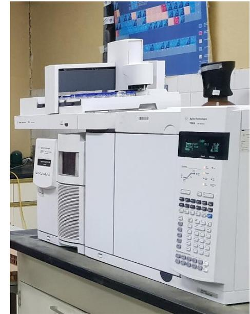
Cromatógrafo de Gases Agilent 7890A acoplado a un
